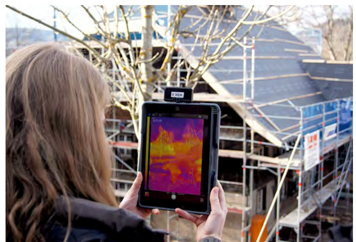
Mithilfe von Wärmebildkameras haben Schüler die Wärmedämmung von Gebäuden untersucht. (Foto: C. Vogelsang, Birklehof)
