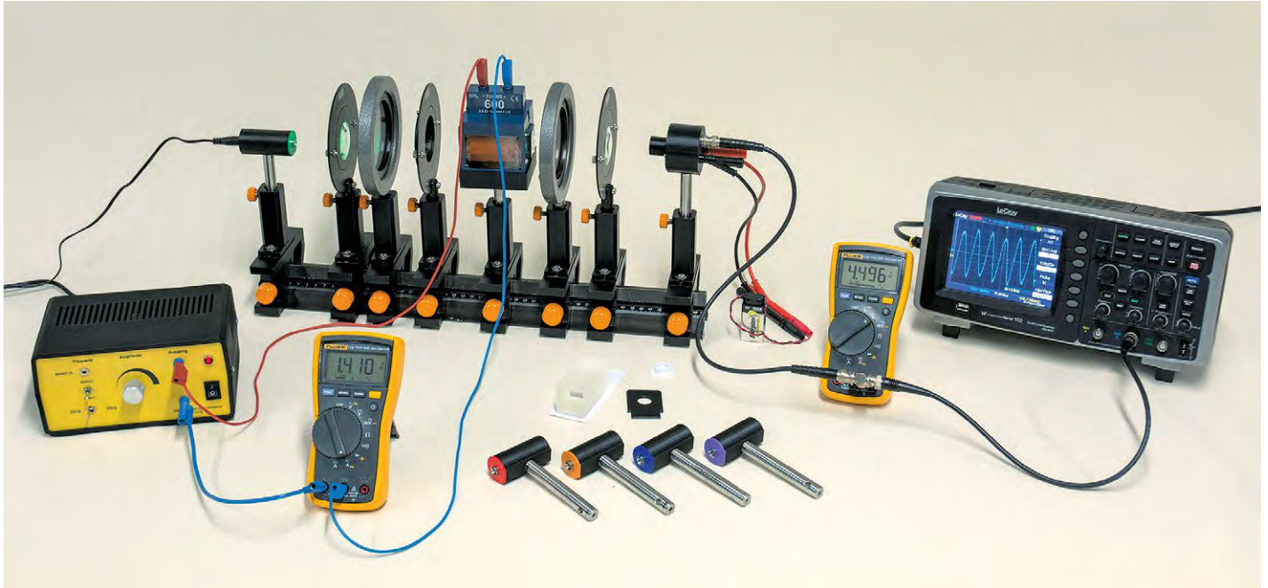
Dieser Versuchsaufbau zur Faraday-Rotation erlaubt vielfältige Experimente zur Atomphysik. (Foto: Ilja Rückmann)
