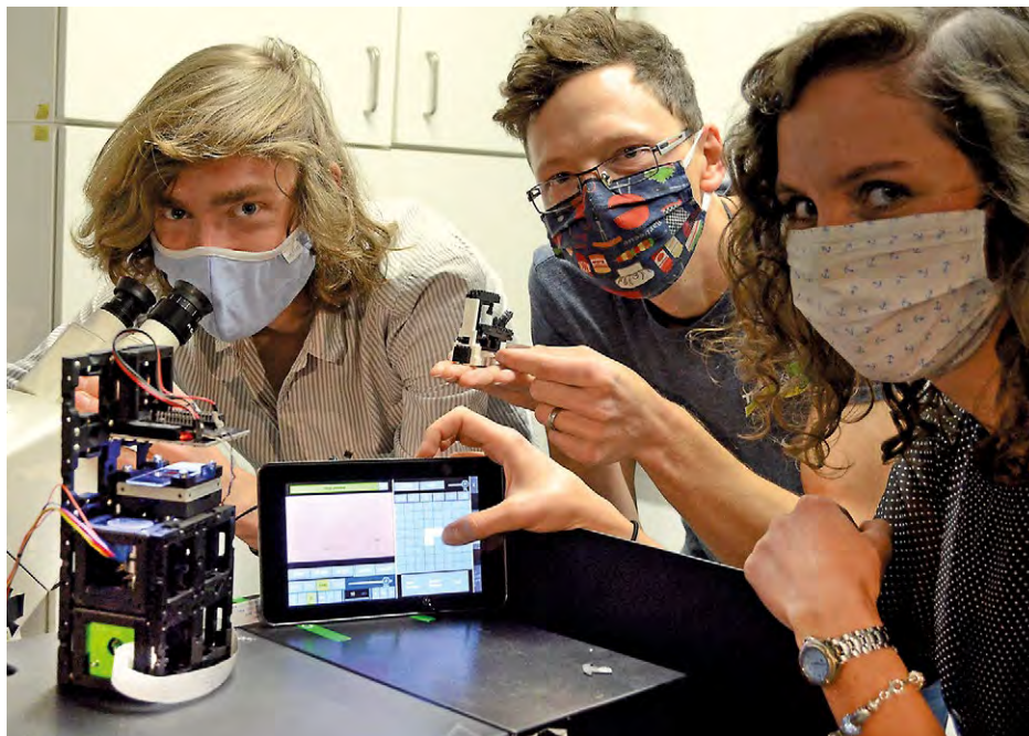
Mit kostengünstig hergestellten Würfeln, die verschiedene optische Komponenten enthalten, lassen sich vielfältige Experimente zur Mikroskopie durchführen. (Foto: IPHT Jena)
